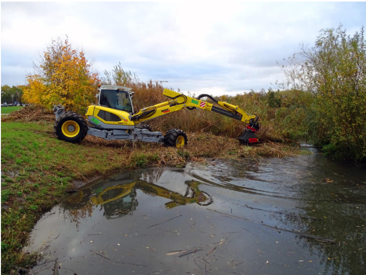
Schreitbagger „Menzimuck“ mäht Schilfbestände am Bucher Landgraben
