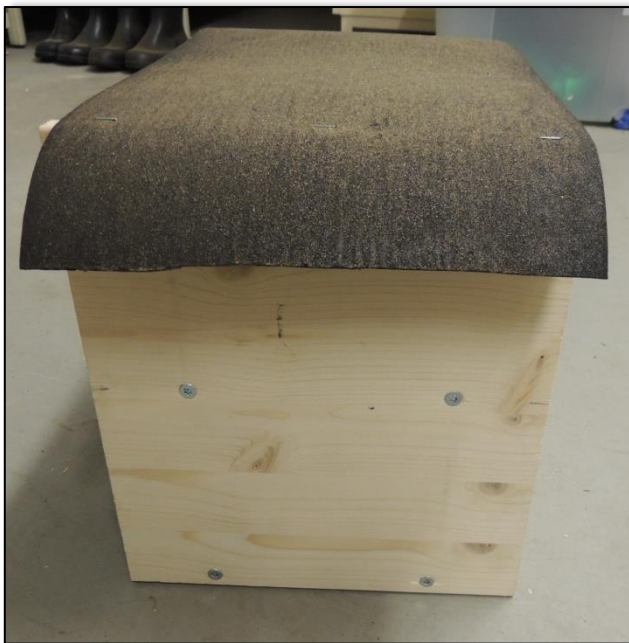
Abbildung 12 – Insektenhotel mit Dach
